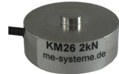
Der Kraftsensor KM26 ist ein Membran-Kraftsensor mit kleinen Abmessungen. Er eignet sich zur Messung von Druckkräften. Der Kraftsensor wird in eine Flachsensung eingepasst und gegebenenfalls mit Klebstoff fixiert. Für die Krafteinleitung ist eine Kalotte mit Radius 40 mm vorgesehen. Die Schutzart ist IP 67. Im Gegensatz zu Kraftsensoren der Baureihe KD (Doppelbalken) führen Querkräfte zu einem Messfehler. Die Krafteinleitung muss daher zentrisch und frei von Querkräften erfolgen.
